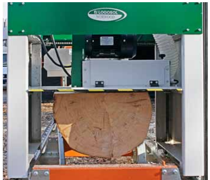
Usinage en deux étapes. Un banc raboté extrêmement stable est produit à partir d'une grume épaisse de 55 cm.
