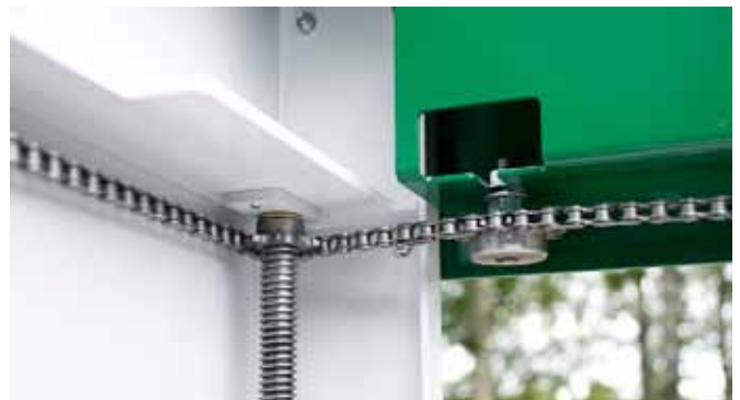
La transmission à chaîne doit fonctionner en souplesse ! La photo montre également le tendeur de chaîne.
