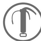
Lorsque ce symbole apparaît lors du montage, les éléments doivent être lubrifiés avant leur installation. Vous pouvez lubrifier les éléments concernés avec de la graisse universelle.
